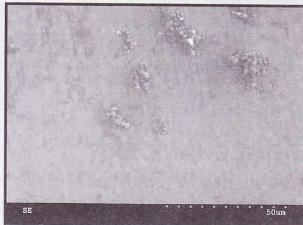
RYS. 6. Morfologia powierzchni powłoki \text{Al}_2\text{O}_3\text{-TiO}_2 po inkubacji w SBF i myciu w myjce ultradźwiękowej w wodzie destylowanej. FIG. 6. SEM image of dual \text{Al}_2\text{O}_3\text{-TiO}_2 coating surface after incubation in SBF and ultrasonic washing in distilled water.
