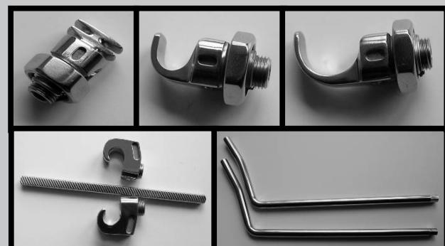
RYS. 1. Postać konstrukcyjna implantów kręgosłupowych poddanych obróbkom elektrochemicznym.
